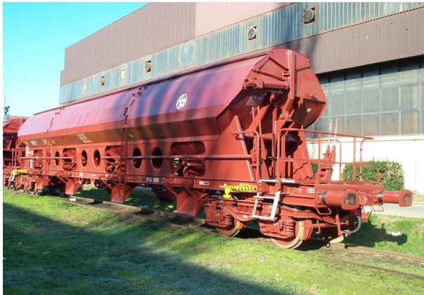
4-osovinski teretni vagon s pokretnim krovom Tadnss-z koristi se za prijevoz rasutih materijala koji ne smiju doći u dodir s vodom (nitrati, granulirano vapno, kalcinirana soda, žitarice i dr.) s granulacijom 0 - 50 mm.
