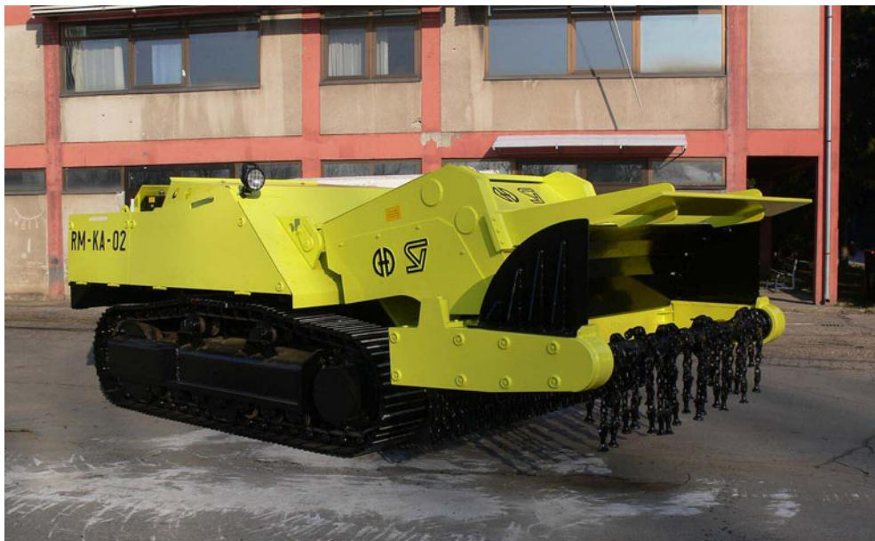
RM-KA-02 je daljinski upravljan stroj za razminiranje, namjenjen za mehaničko čišćenje minama onečišćenih područja uklanjanjem svih tipova raslinja (nisko, srednje i visoko), prerađom II-V kategorije tla (otkidanjem, kopanjem i mljevenjem) i uništavanjem svih vrsta protupješačkih i protutenkovskih mina (aktiviranjem, otkidanjem i mljevenjem).
